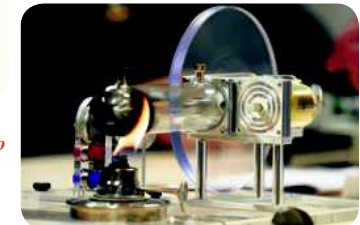
Stirlingov motor pokreću zagrijane molekule zraka
